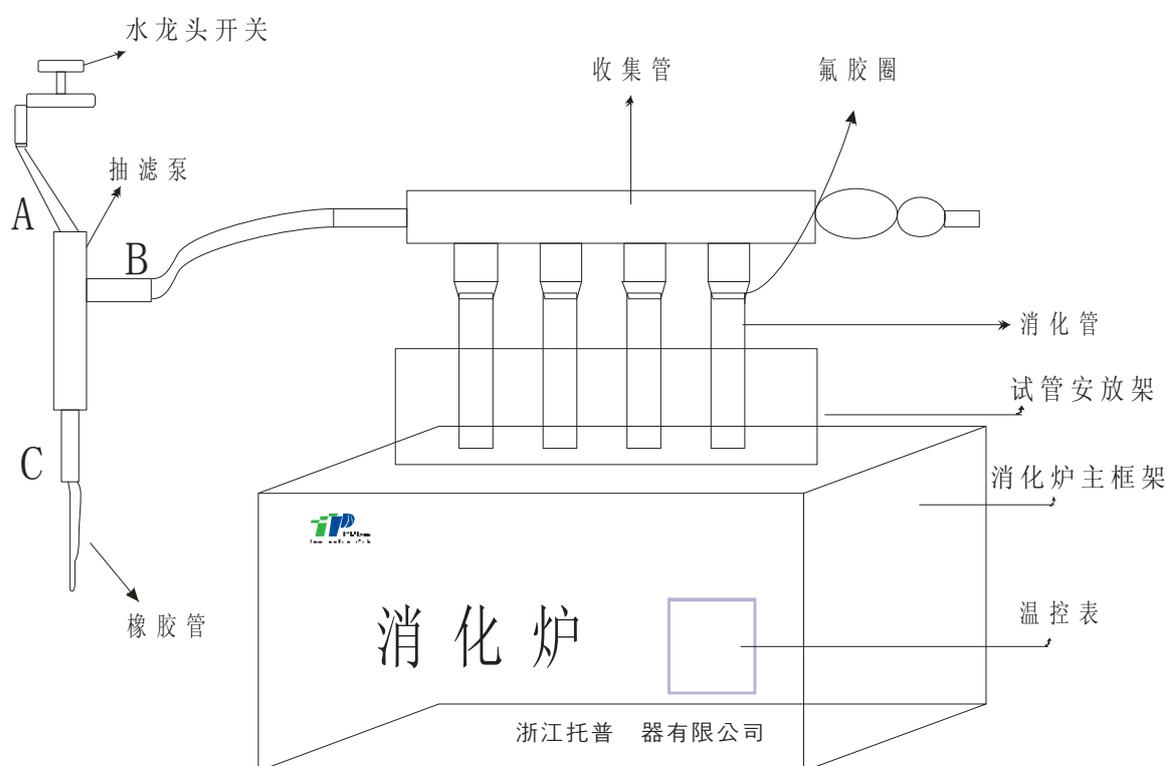
抽滤泵 A 端用橡皮管同水龙头连接，B 端用橡皮管与排污收集管排气口连接，C 端接橡皮管置入下水道，B 端连接橡皮管不宜过长，消化排污时自来水流量应当适当（3-4L/分钟），保证抽滤泵的吸力，使废气与自来水一起排入下水道中。
