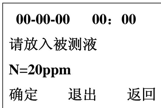
将仪器顶部右侧的测试装置方盖打开，取出标准液比色杯，放入被测液比色杯（光面对准光源），
